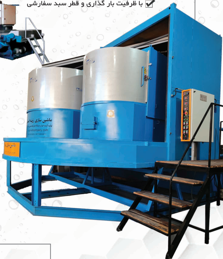
دستگاه M2200s به همراه سیستم گرمایشی برقی
